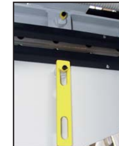
Chiavistello per bloccaggio piani in fase di manutenzione Safety lock Verriegelungshaken für die Heizplatte bei Wartungsarbeiten
