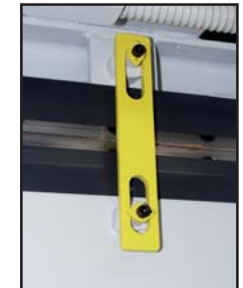
Chiavistello per bloccaggio piani in fase di manutenzione Safety lock Verriegelungshaken für die Heizplatte bei Wartungsarbeiten
