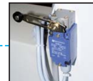
Finecorsa apertura piano Limit switch for press opening Endschalter "Öffnung Presse"
